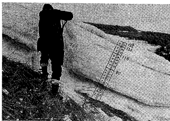
図2 北海道に多い霜ざらめ雪（地面から上40cmまでの層）に起因する 雪崩の破断面。キラキラ光る砂糖のような結晶が崩れやすい。
